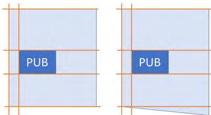
*Implantation parallèle par rapport au support, dans le cas d'un sol horizontal (à gauche) ou dans le cas d'un sol en pente (à droite).*
