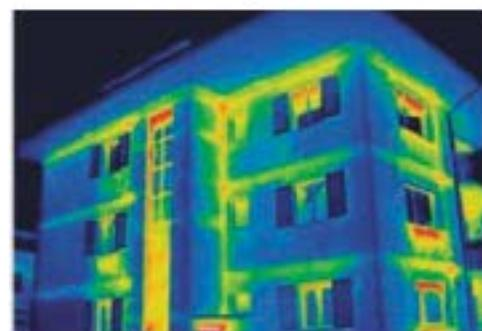
disposition une caméra thermique. Celle-ci vous permettra de visualiser par un jeu de couleurs, les zones froides et chaudes, et ainsi de détecter les défauts d'isolation, les déperditions de chaleur importantes et les ponts thermiques.
