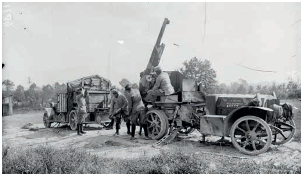
Vienne-le-Château (Marne). Auto canon de 75 mm De Dion-Bouton FZ contre avion et caisson à munitions modèle 13, SPA 26 L 128g © Albert Samama-Chikli/ECPAD/
