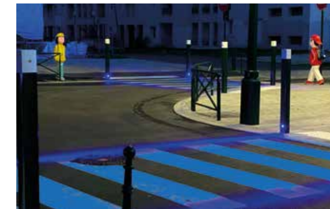
Éclairage led basse consommation avec détecteur de présence et poteaux lumineux à lumière bleue pour sécuriser la traversée, renforcée par des coussins berlinois
