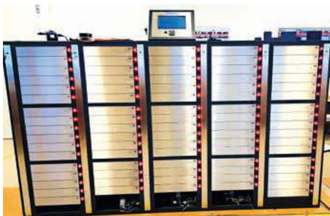
Les agents déverrouillent un tiroir de l'armurerie connectée en scannant leur badge. Le tiroir qui s'ouvre ne contient ainsi que les équipements pour lesquels chaque agent dispose des habilitations
