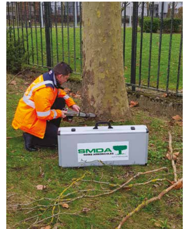
Sondage au pénétromètre pour évaluer la santé d'un Platane
